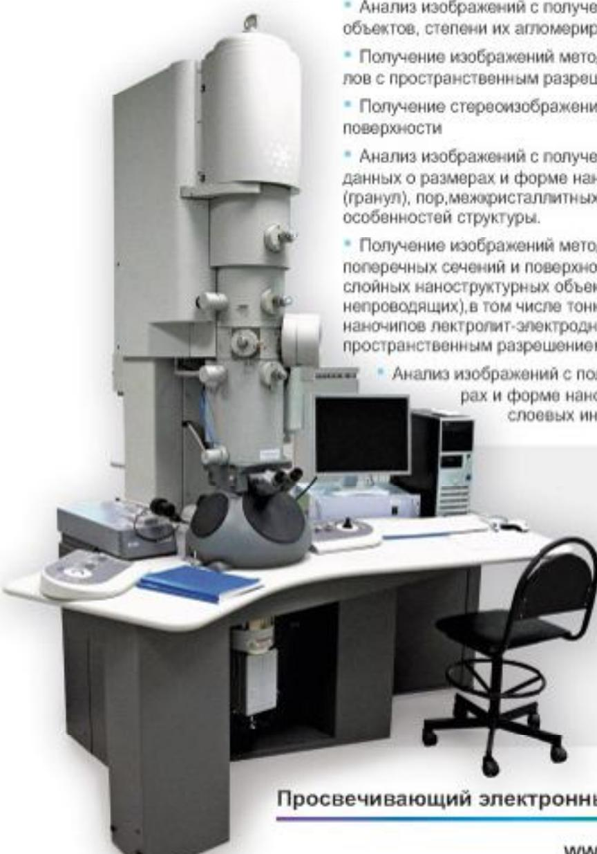
Просвечивающий электронный микроскоп Тесла G2 F20 U-TWIN
