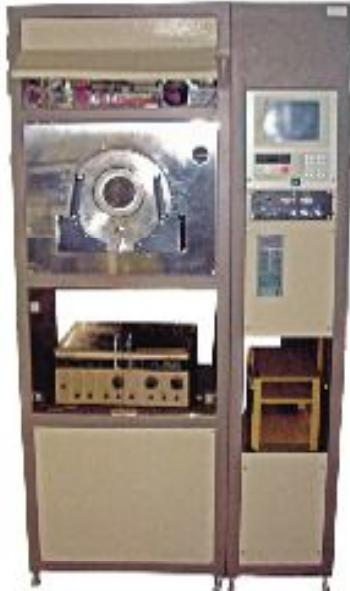
**Установка низкочастотного плазмохимического осаждения для формирования нитридных, оксидных и аморфных слоев на кремнии**
