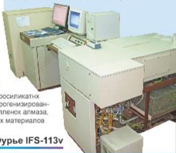
Спектрометр ИК Фурье IFS-113v
