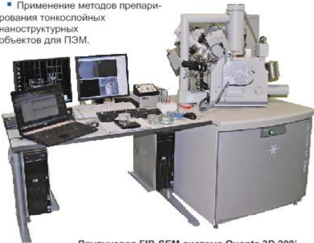
Двухлучевая FIB-SEM система Quanta 3D 200i
