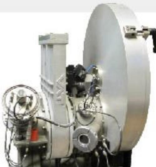
Установка ионной имплантации K2MV
